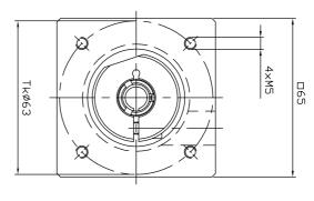
Abtriebswellenlagerung: Rillenkugellager 2RS
