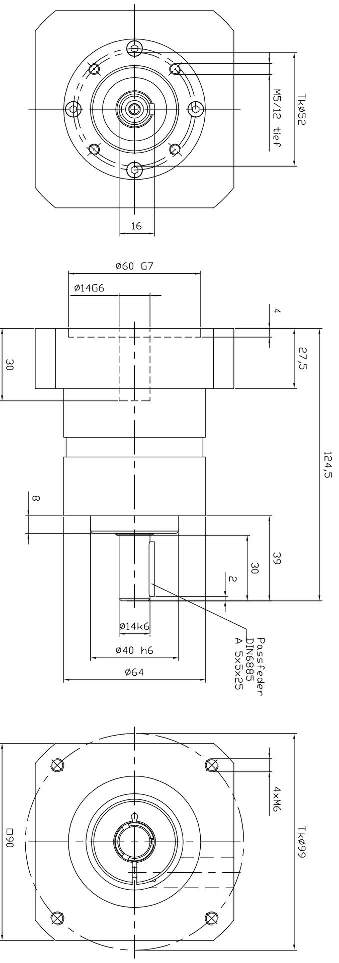
**Abtriebswellenlagerung: Rillenkugellager 2RS**
