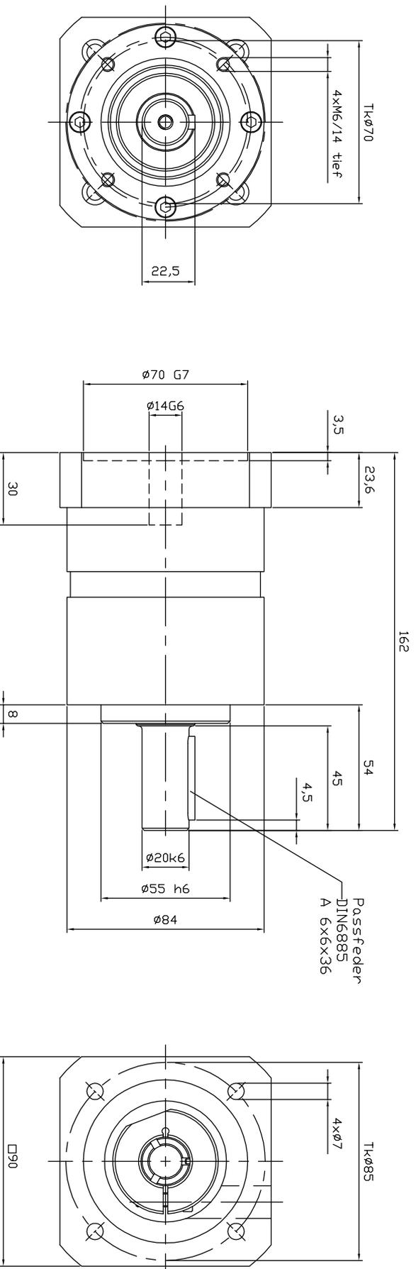
**Abtriebswellenlagerung: Rillenkugellager 2RS**
