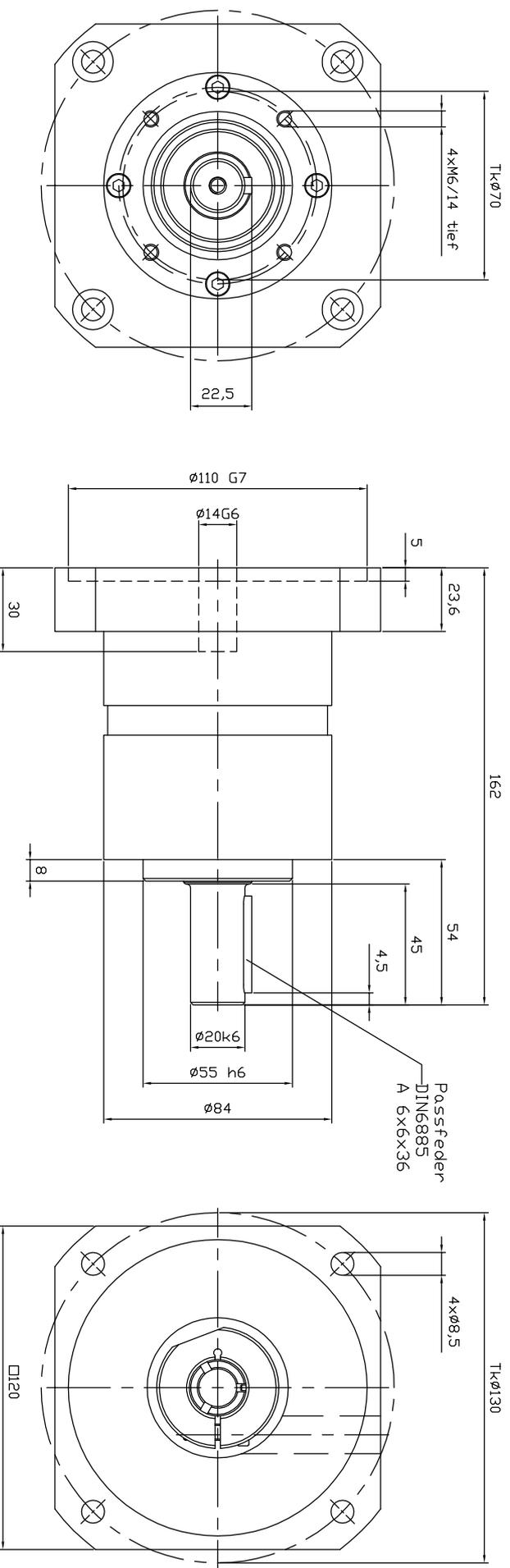
**Abtriebswellenlagerung: Rillenkugellager 2RS**
