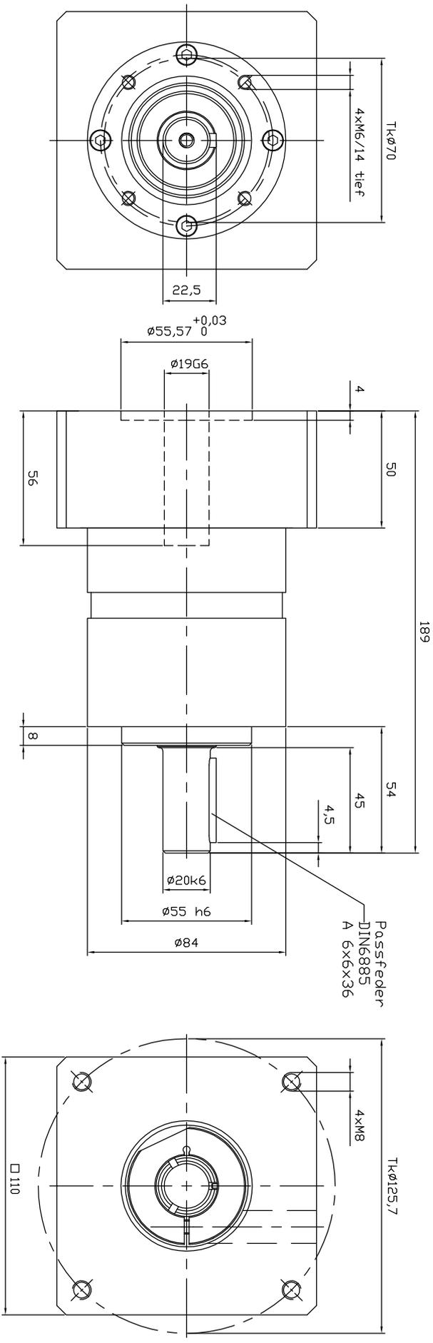
**Abtriebswellenlagerung: Rillenkugellager 2RS**
