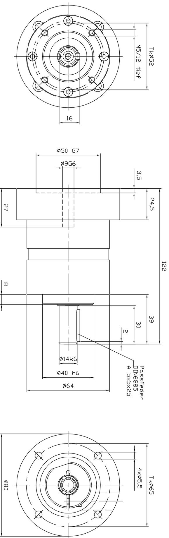
**Abtriebswellenlagerung: Rillenkugellager 2RS**
