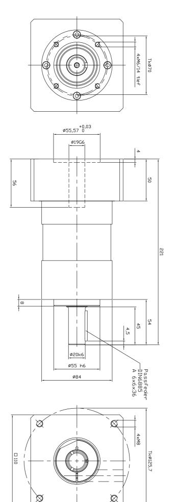
Abtriebswellenlagerung: Rillenkugellager 2RS
