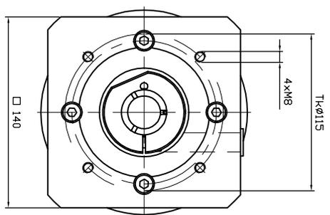
**Abtriebswellenlagerung: Rillenkugellager 2RS**
