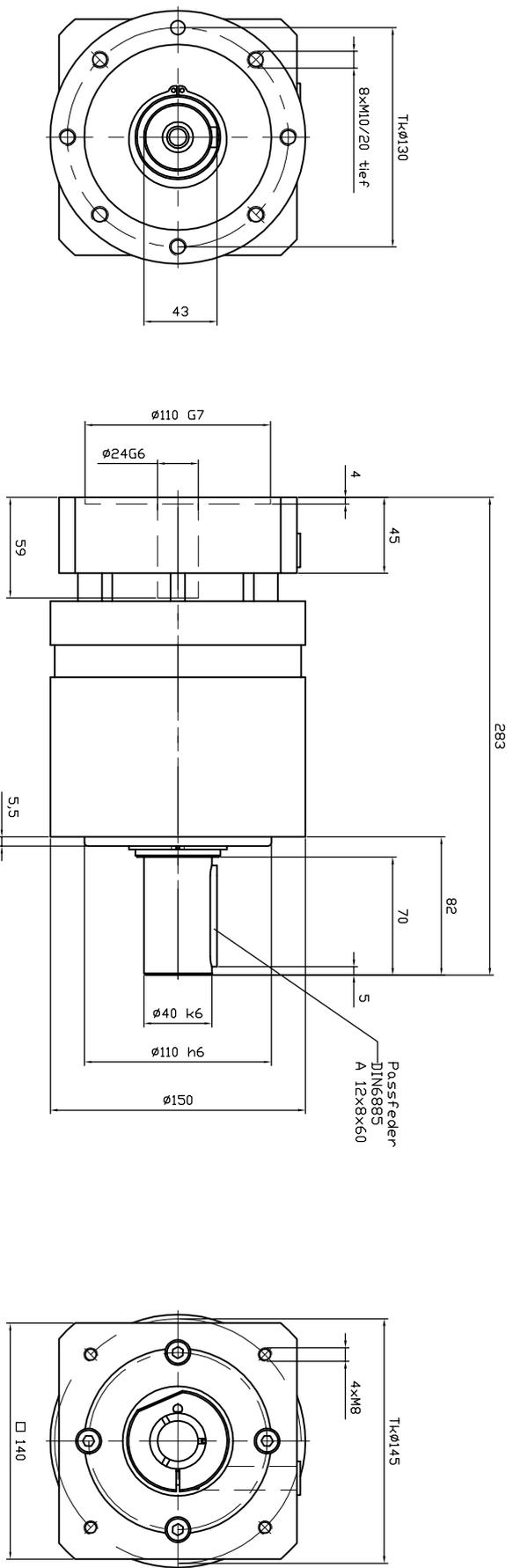
**Abtriebswellenlagerung: Rillenkugellager 2RS**
