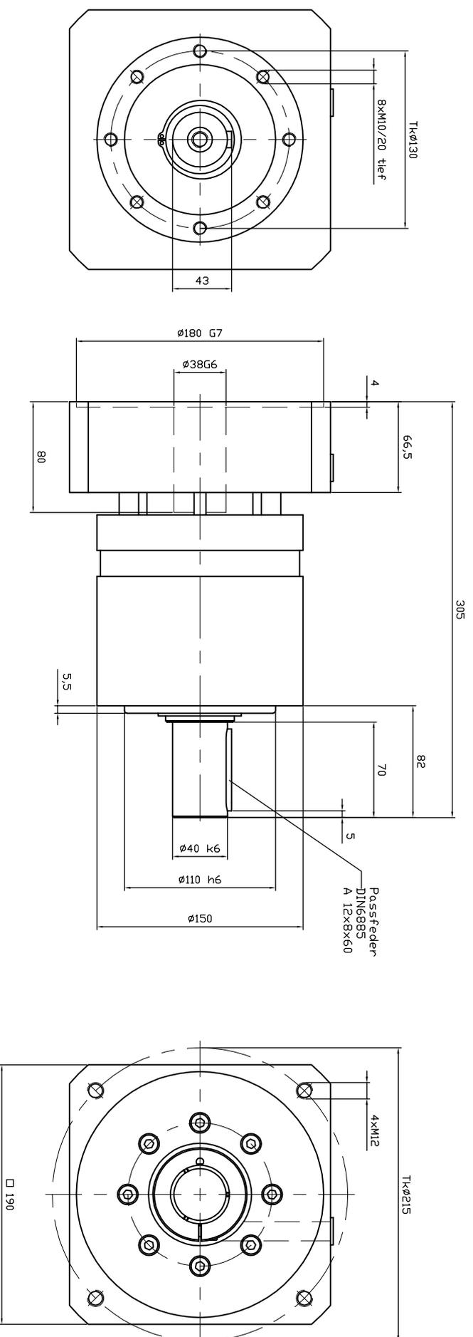
**Abtriebswellenlagerung: Rillenkugellager 2RS**
