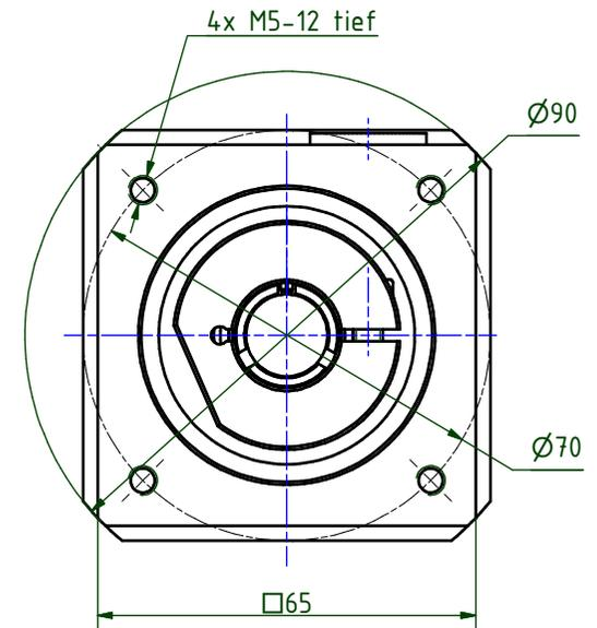
Abtriebswellenlagerung: Rillenkugellager 2RS
